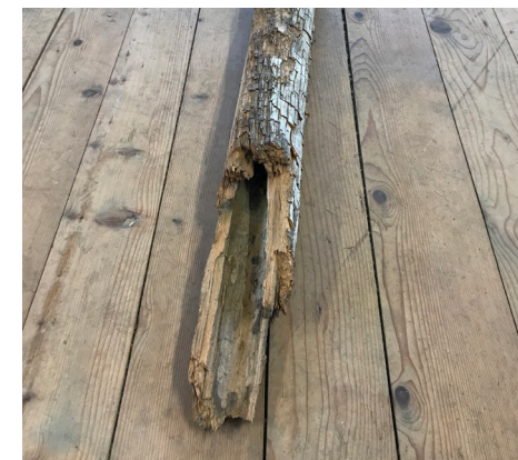
Mit langem Handbohrer ausgehöhlter Dünkel als Wasserleitung
